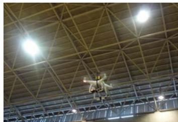
◎ ドローンをを用いたLED照明の輝度測定風景
