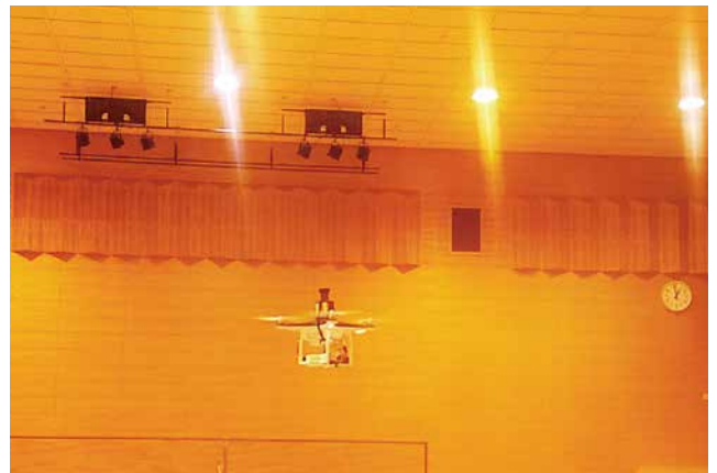
図3 アリーナ内を飛行するドローン(アリーナの輝度の測定中)
