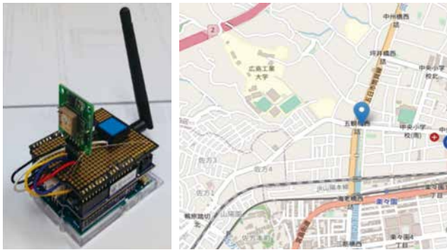
図4. Sigfox通信機能付きGPS装置(左)、及びGPS装置の地図上の位置(右、青印)
