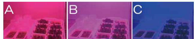
図2 LED照明による植物の栽培 (A) 赤色光、(B) 赤色/青色混合光、(C) 青色光
