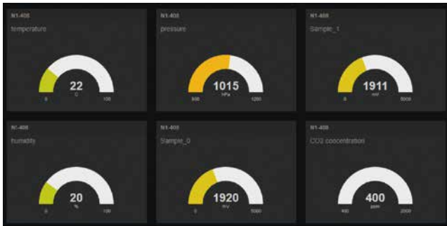
図5. Sigfox通信機能付きの温度、湿度、気圧、CO2濃度センサーのデータを、sigfox cloudと、dweet.ioを経由して、リアルタイムで、Freeboardで表示。
