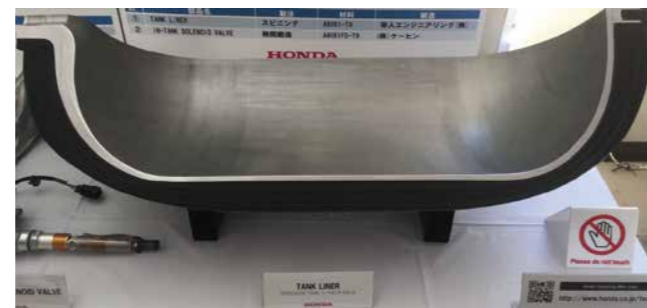
ホンダ燃料電池車に搭載されている 高圧水素貯蔵容器(Type:HV3) (アルミニウム合金+CFRP) 耐水素脆性が要求される
