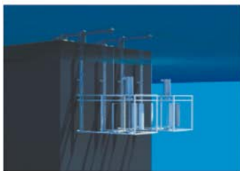
橋脚・港湾構造物を利用した潮流発電
